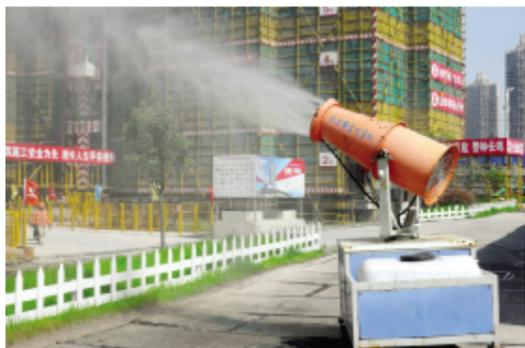
可移动除尘雾炮机,对尘埃有较强的穿透力和雾珠附着力,能有效防尘降尘
